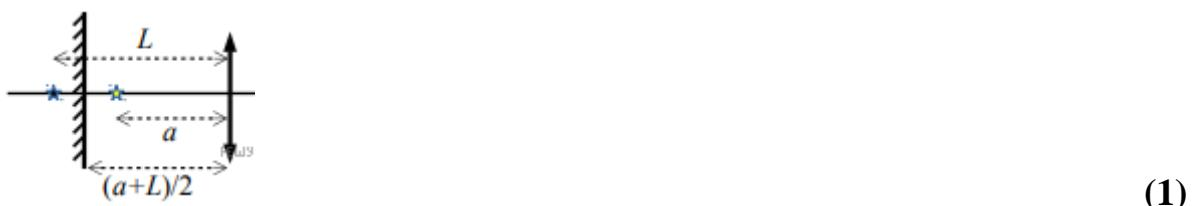
Такое изображение получается, когда свет от предмета попадает на зеркало, ни разу не пройдя сквозь линзу. Легко понять, что зеркало должно быть с той же стороны от линзы, что и предмет, и располагаться на расстоянии  $a=F$ :
